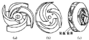
图 19-3 叶轮的型式 (a) 开式叶轮; (b) 半开式叶轮; (c) 闭式叶轮
